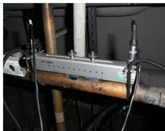
Ces mesures ont été effectuées à l'aide d'un débitmètre équipé de capteurs à ultrason de marque ULTRAFLUX.
