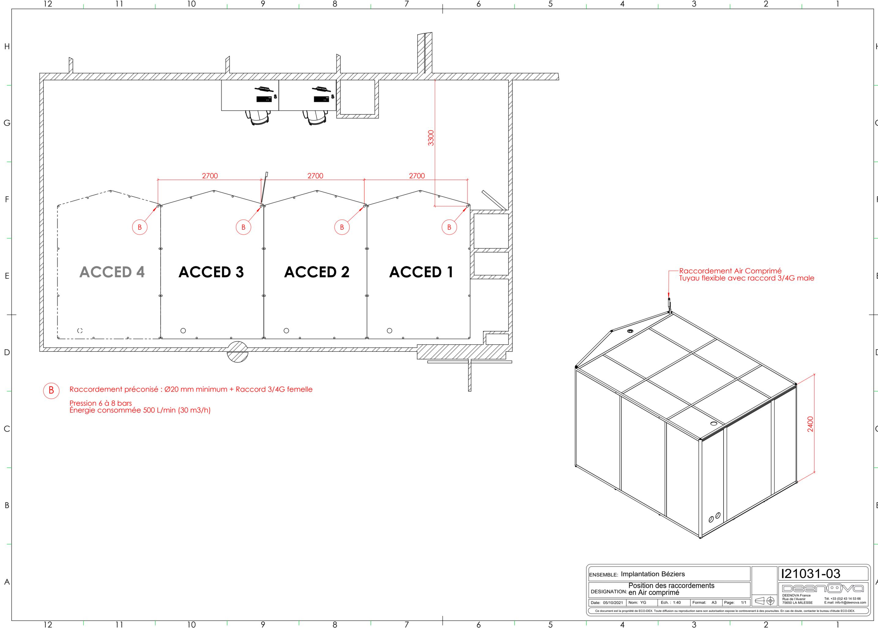
**B** Raccordement préconisé : Ø20 mm minimum + Raccord 3/4G femelle
